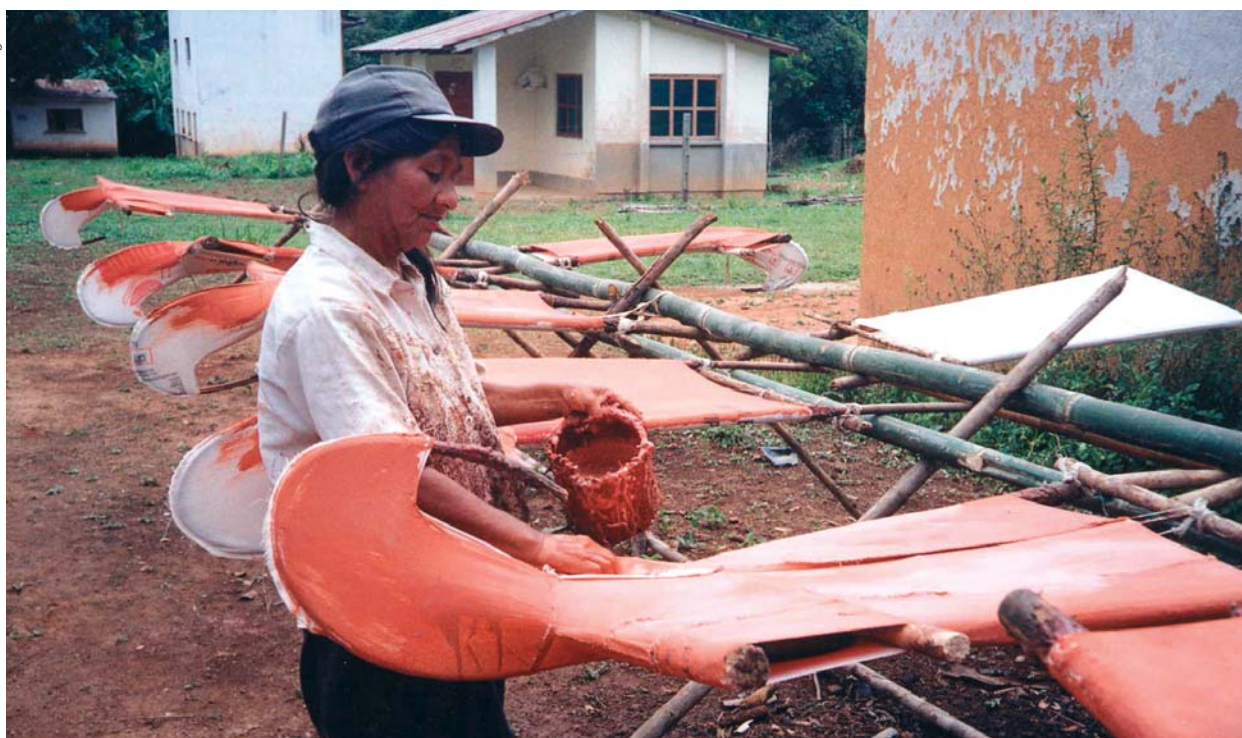
Confección de ponchos impermeables con recortes de tela que se cubren de goma látex. Santa Rosa, Bolivia.
